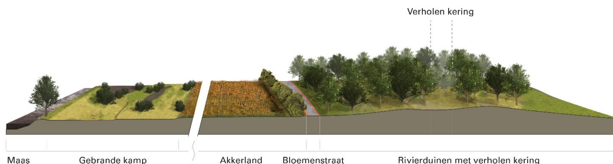
Afbeelding 20: Perspectiefdoorsnede verborgen waterkering gecombineerd met rivierduinen
